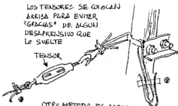
TODOS LOS CABLES SE SUJETAN CON SUJETACABLES
