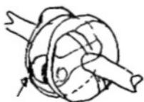
UNA SOLDADURA. DESPUES DE ESTO HAY QUE EQUILIBRAR ESTE EJE. PARA ELLO HAY QUE QUITAR LAS BOBINAS DEL MAGNETO PARA QUE ÉSTE NO TENGA PUNTOS RESISTENTES
