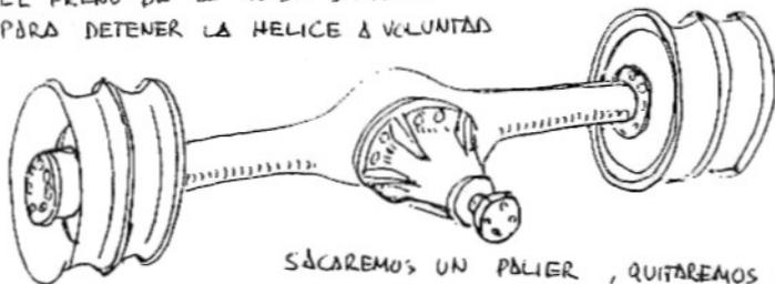
SACAREMOS UN PALIER , QUITAREMOS LA LLANTA DEL OTRO LADO Y CORTAREMOS EL EJE POR LO MARCADO
